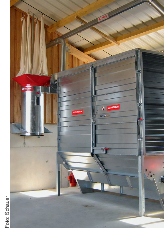
△ Mit der Strohmatic-Anlage kann man Quader- oder Rundballen auflösen, häckseln, entstauben und in die Bucht transportieren.
